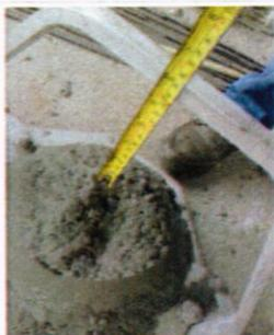
Vista de Prueba de Revenimiento del concreto en la fundicion de vigas del nivel 3:+12.00; 17-07-2017
