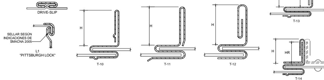
JUNTAS TRANSVERSALES PARA CONDUCTOS RECTANGULARES
