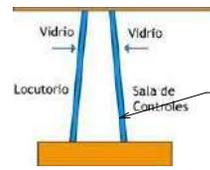
VENTANA TIPO PECERA, CON VIDRIO DOBLE DE 8mm, 10° DE INCLINACIÓN VERTICAL Y CÁMARA DE VACÍO DE 15 CMS ENTRE ELLOS. MARCO DE MADERA Y SELLADO HERMÉTICO CON SILICONA
