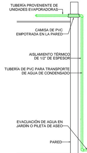
TUBERÍA DE CONDENSADO
