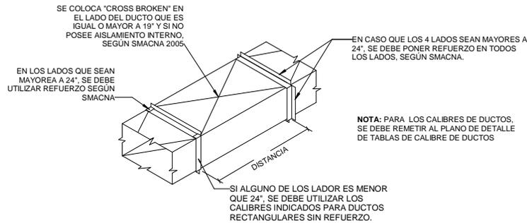
○ UNIÓN Y REFUERZO DE DUCTOS RECTANGULAR
