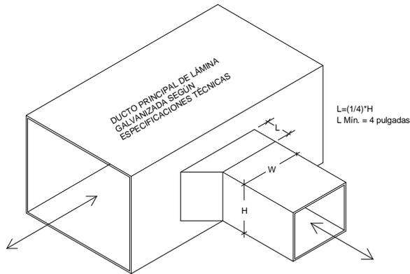
DERIVACIÓN TÍPICA EN CONDUCTOS RECTANGULARES
