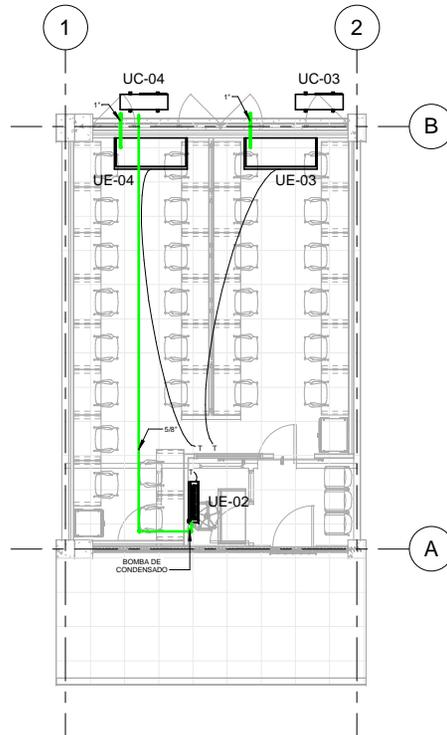
1 SALA DE REDACCIÓN-TUBERÍA DE DRENAJE
