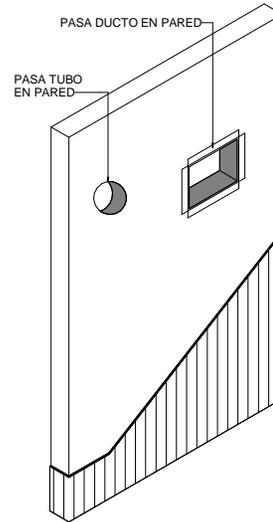
PASANTE DE DUCTOS Y TUBERÍA EN PARED
