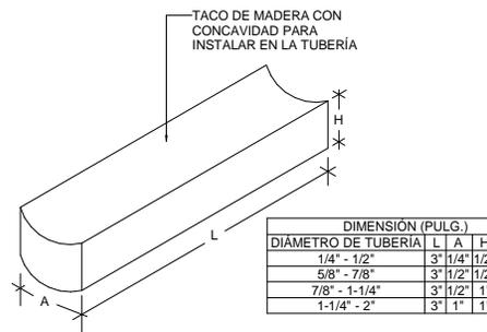
○ TACO DE MADERA PARA TUBERÍAS
