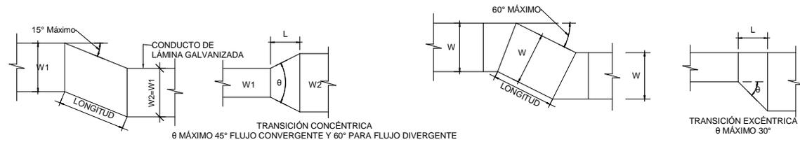
CAMBIO DE ALTURA EN CONDUCTOS RECTANGULARES
