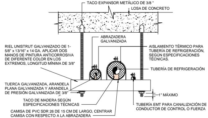
**NOTA:** APLICAR DOS MANOS PINTURA ANTICORROSIVA DE DIFERENTE COLOR EN TODOS LOS PUNTOS DE CORTE DE LOS ELEMENTOS QUE CONFORMAN EL SOPORTE DE TUBERÍA
