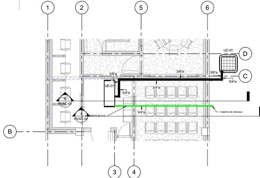
② DIMENSIONAMIENTO DE TUBERÍA DE REFRIGERACIÓN Y DRENAJE
