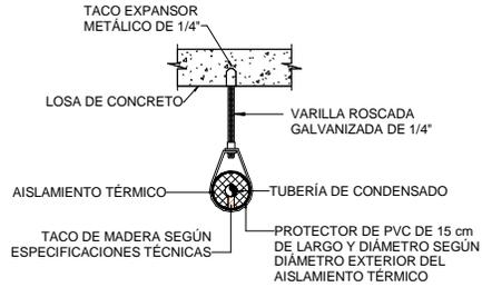
○ SOPORTE DE TUBERÍA DE CONDENSADO
