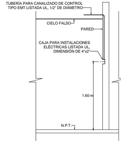
○ INSTALACIÓN DE TERMOSTATO EN PARED
