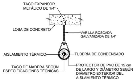
**SOPORTE DE TUBERÍA DE CONDENSADO**
