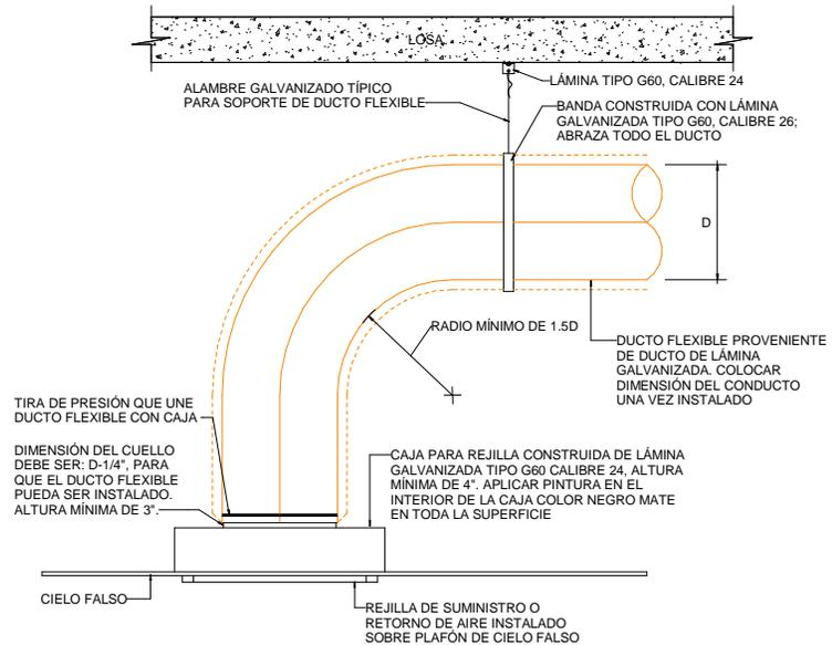
**INSTALACIÓN DE DUCTO FLEXIBLE**
