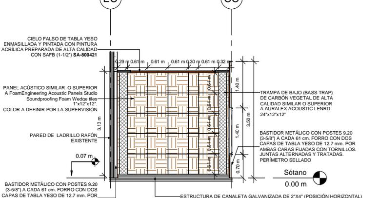
ESTRUCTURA DE CANALETA GALVANIZADA DE 2"x4" (POSICIÓN HORIZONTAL) @ 0.61m CON TARIMA DE MADERA MACHIHEMBADA DE 1"x4"
