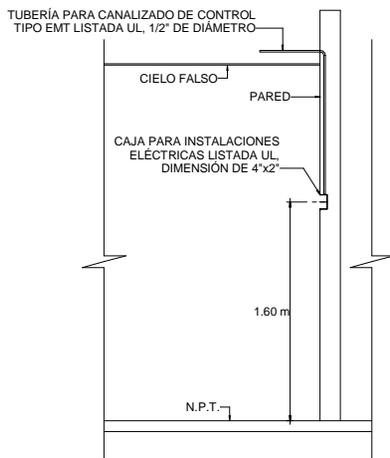
○ INSTALACIÓN DE TERMOSTATO EN PARED
