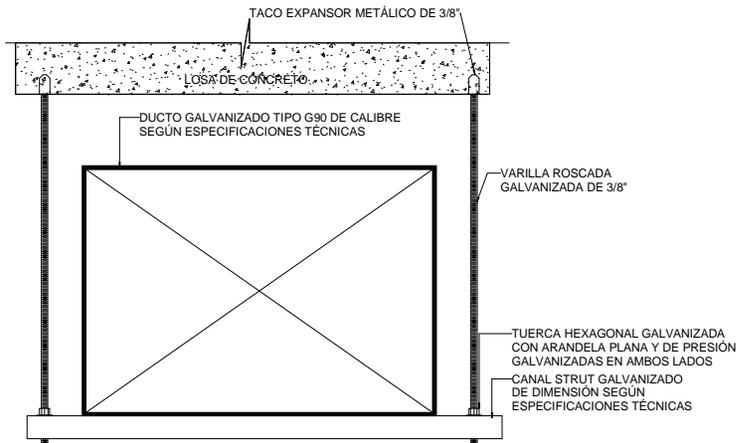
NOTA: COLOCAR DOS MANOS DE PINTURA ANTICORROSIVA DE DIFERENTE COLOR Y DIFERENTE LONGITUD EN TODOS LOS CORTES DE LOS ELEMENTOS DE SOPORTE
