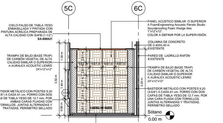
ESTRUCTURA DE CANALETA GALVANIZADA DE 2"x4" (POSICIÓN HORIZONTAL) @ 0.61m CON TARIMA DE MADERA MACHIHEMBADA DE 1"x4"
