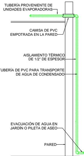
TUBERÍA DE CONDENSADO
