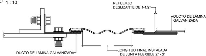
INSTALACIÓN DE CONECTOR FLEXIBLE EN EQUIPO
