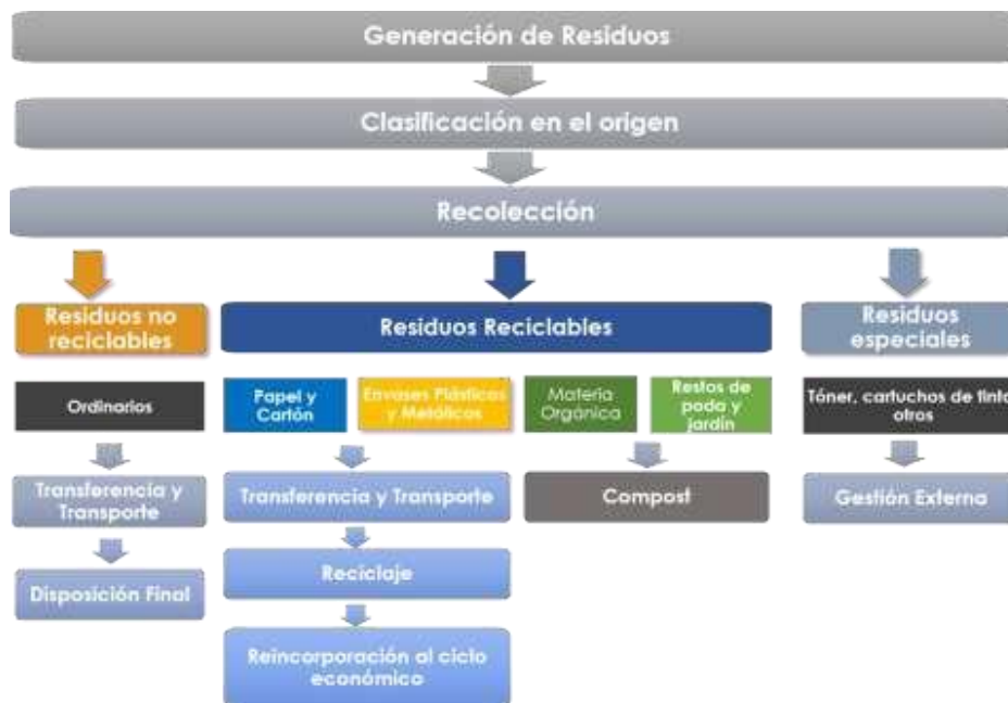
Esquema 2. Diagrama del modelo de gestión de residuos sólidos a ser implementado en el Edificio 1847
